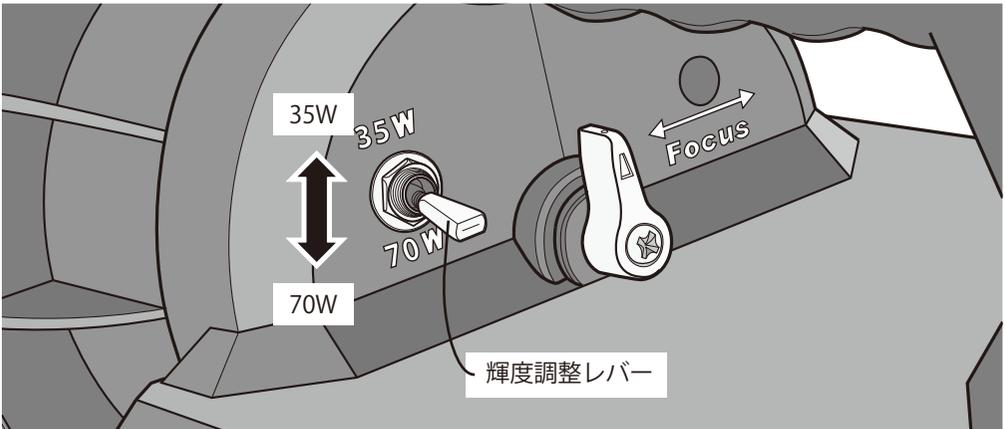
レバーを上げる・・・輝度 35W（照射距離 800m / 光束 3300lm / 連続使用約3時間）
