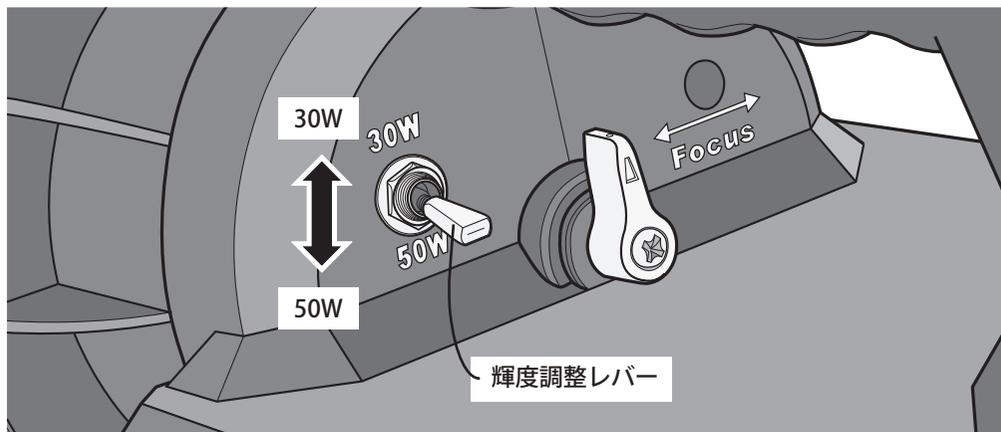
レバーを上げる・・・輝度 30W（照射距離 600m / 光束 2700lm / 連続使用約 2 h 20min）
