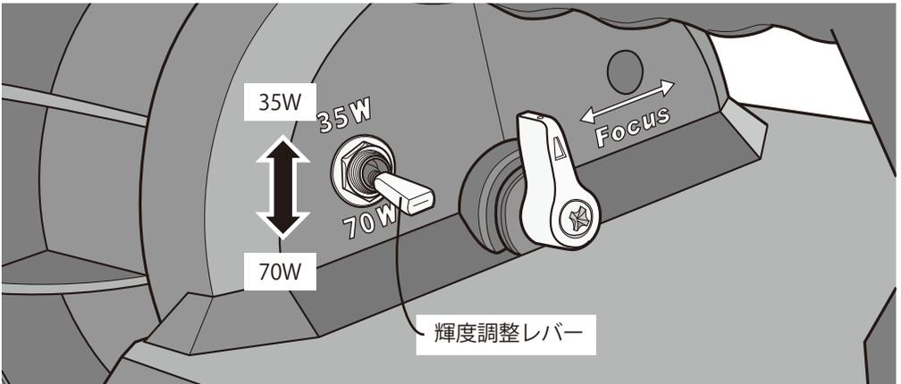
レバーを上げる・・・輝度 35W（照射距離 1400m / 光束 3300lm / 連続使用約3時間）
