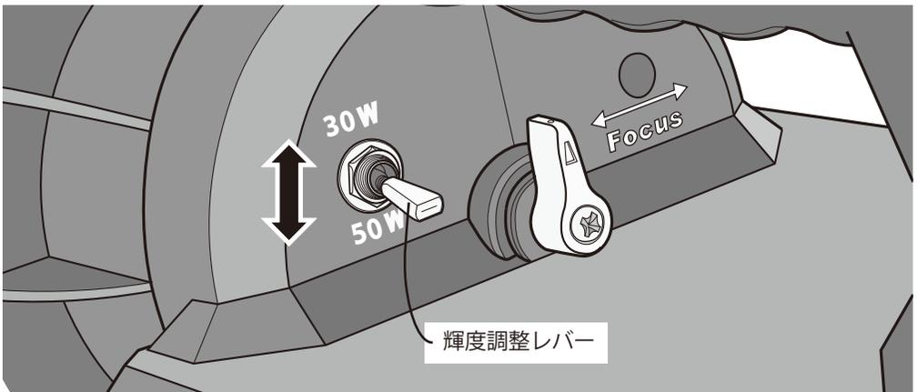
レバーを上げる・・・輝度 30W（照射距離 600m / 光束 2700lm / 連続使用約4時間）
