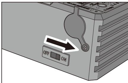
②誤作動防止カバーを上を持ち上げ、点灯スイッチを押す。
